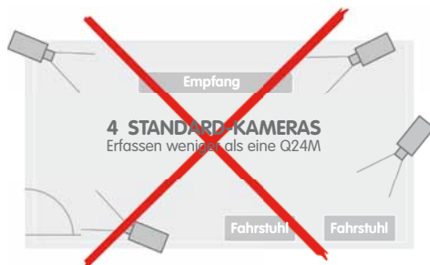
Hemisphärische Raumerfassung bei Wandmontage - eine Q24M statt 4 Standard-Kameras
